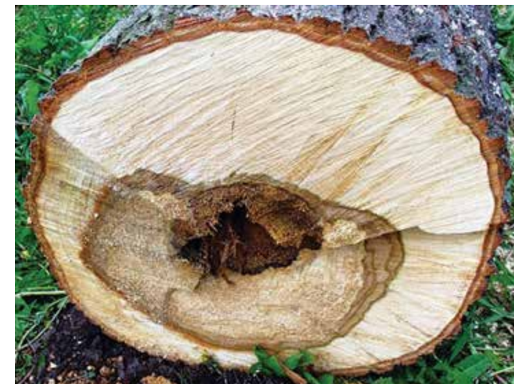
Ядровая гниль – наиболее значимый из пороков строения древесины
