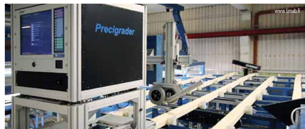
Прочностная сортировка пиломатериалов Precigrader www.limab.fi
