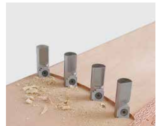
Подготовка поверхности торцовым фрезерованием – система Rotoles www.ledinek.com
